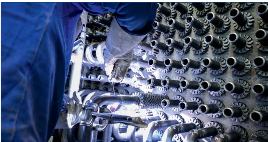
Fertigung eines Wärmetauschers. Mit dem jahrzehntelangen Know-how in der Schweißtechnik verstärken die Meeraner ihre Serviceleistungen am Markt.
