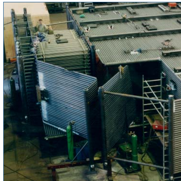
Kessel für eine Müllverbrennungsanlage. Das Unternehmen konzentriert sich auf Komponenten für Energietechnik & Kraftwerksbau sowie den verfahrenstechnischen Anlagenbau.
